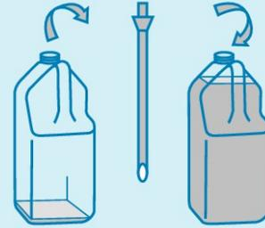
4. Sacar con cuidado el tubo de aspiración. Desenroscar el tapón del nuevo bidón, introducir el tubo de aspiración y volver a colocar el bidón en su soporte.
