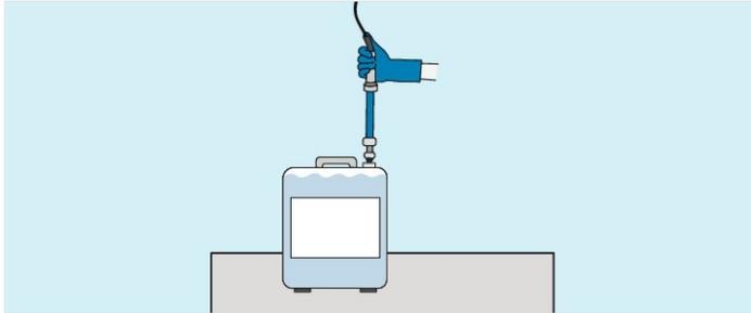
4. Conectar el producto con el sistema de dosificación a través de la caña de aspiración correspondiente.
